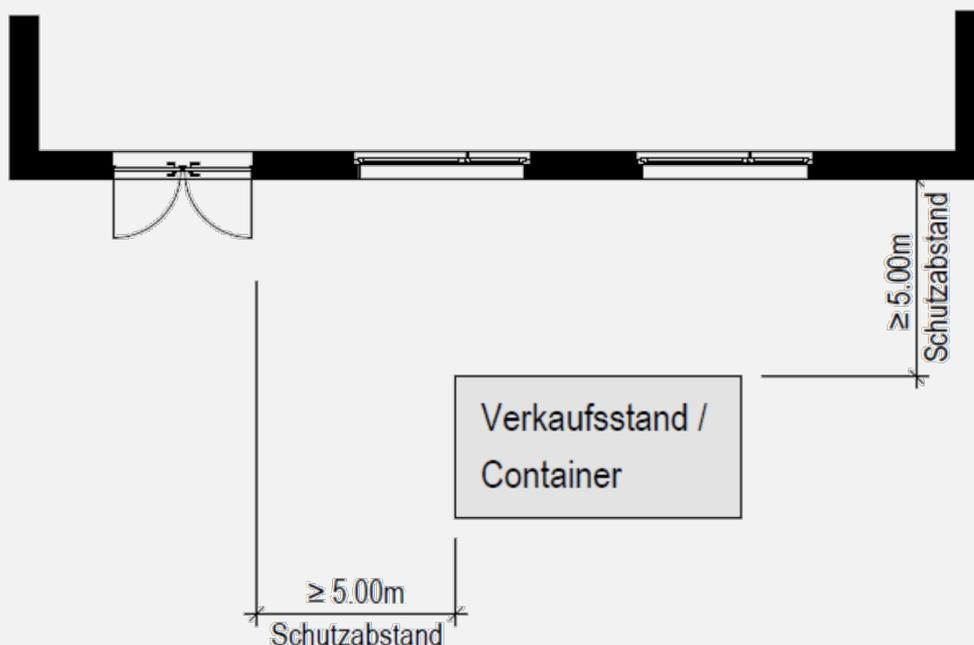
**Unterabstände zu brennbaren Fassaden und Schaufenstern**
